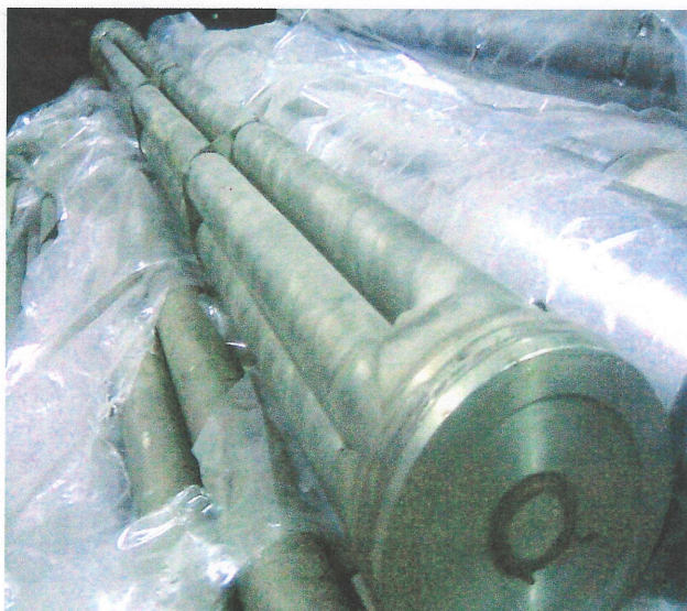
Рисунок 1. Донная часть чехла Т-26 с приваренной заглушкой
