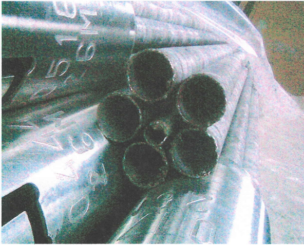
дезактивированный чехол с отделёнными головной и хвостовой частями
