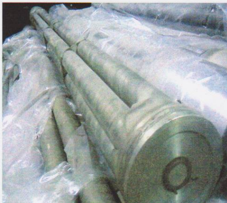
Рисунок 1. Донная часть чехла Т-26 с приваренной заглушкой
