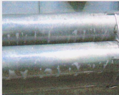
после замачивания в растворе в течение часа
