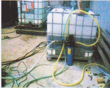
бак ёмкостью 1 м 3 с раствором IFT-D и механический фильтр 5 микрон.
