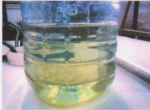
обмывочная вода, прошедшая очистку от механических примесей и коагулята
